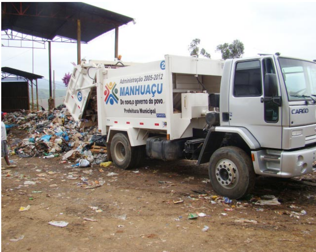
O caminhão prensa agiliza o recolhimento e armazena maior quantidade de lixo.
