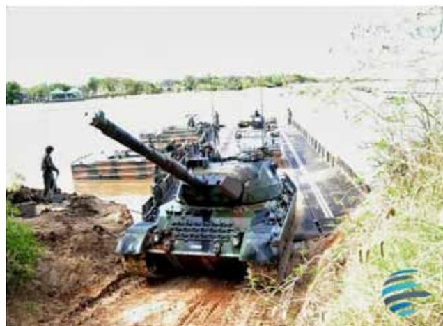
hão de Engenharia de Combate Blindado realizaram a montagem de uma passadeira de alumínio, de duas portadas tática leve classe 16 e de uma portada modular pesada Krupp classe 70.
